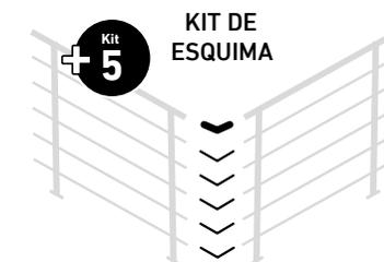
El kit completo tiene una longitud de 150 cm o 250 cm y puede ser recortado o ampliado; los kits adicionales pueden fijarse rápidamente y fácilmente en cualquier momento. Las varillas son de aluminio acabado texturado RAL 7016 de 16 mm Ø.
