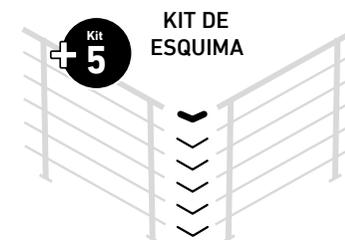
El kit completo tiene una longitud de 150 cm o 250 cm y puede ser recortado o ampliado; los kits adicionales pueden fijarse rápidamente y fácilmente en cualquier momento. Las varillas son de aluminio acabado plateado de Ø 16 mm.
