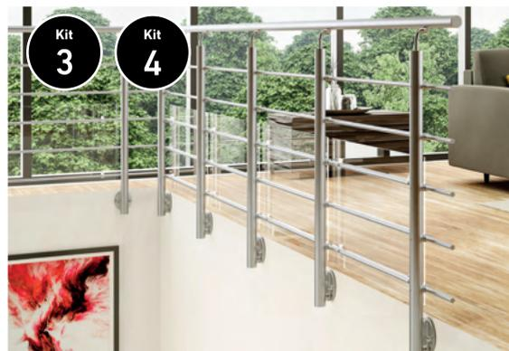
Adaptar su balaustrada a las normas NF P01-012 y NF P01-013/ Normas francesas que establecen las dimensiones de las balaustradas con fines de seguridad. Para una altura de caída superior a 1 m: Panel de vidrio acrílico 4x950x500mm - A25/Soportes para A25. La distancia entre los ejes de los postes no debe superar los 1000mm - El pasamanos debe ajustarse a una altura superior a los 1000mm del suelo.
